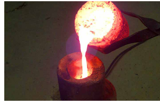
Im selbst gebauten Grubenofen werden Kupfer und Zinn aufgeschmolzen und in eigenen Formen verarbeitet. (Foto: Thorsten Helmerking)
